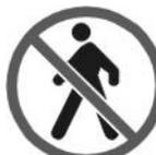
È vietato sostare nel raggio di azione della macchina quando questa è in moto. Nessuna persona o animale può sostare in un raggio di cinque metri dalla macchina durante il normale funzionamento della stessa.
