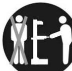
Der Holzspalter muss von einer einzigen Person bedient werden.
