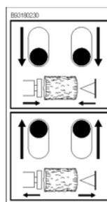
Comando a due mani: premendo entrambe le leve contemporaneamente verso il basso, la lama si aziona conficcandosi nel tronco. Una volta spaccato il tronco, spingere verso l'alto le leve per far tornare la lama nella posizione superiore, pronta per un nuovo ciclo.
