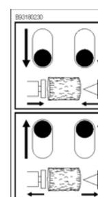
Commande à deux mains: activant les deux leviers en même temps vers le bas, la lame se mettra en marche et s'enfoncera dans la bûche. Une fois que le tronc est fendu, pousser les leviers vers le haut afin d'apporter la lame en position supérieure, prête pour un nouveau cycle de travail
