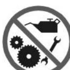
Wartungs- oder Reparaturarbeiten nie bei in Betrieb stehender Maschine ausführen.
