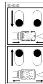
ZHB-Steuerung: Wenn die Hebel gleichzeitig nach unten betätigt werden, das Schneidblatt bewegt sich und es wird in den Stamm hineingetrieben. Sobald der Stamm ist gesplattet, den Hebel nach oben betätigen. Das Messer läuft in der Anfangsposition zurück, bereit für ein neues Zyklus.
