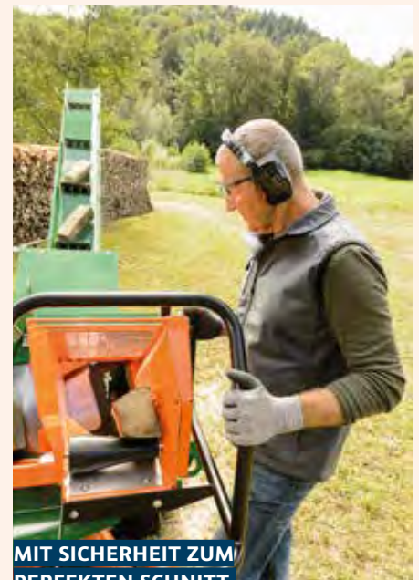
METERHOLZ EASY SÄGEN – MIT AUTOMATISCHEM HOLZVORSCHUB
